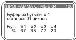
Рисунок 8. Дисплей при работающей программе и с подключённым терминалом контроля объема жидкости
